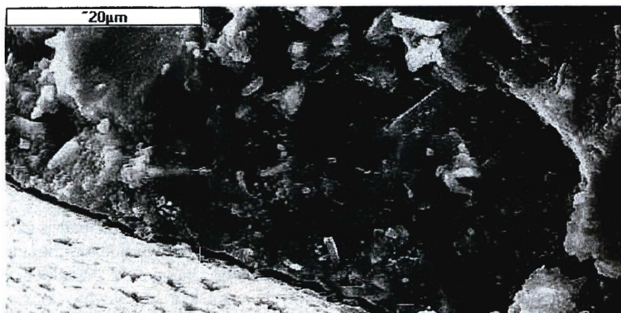
Rys. 5. Strefa kontaktowa: kruszywo-zaczyn w próbkach betonów z cementem C2, pow. \times 2000 ; a) p/c=0.0 , b) p/c=0.095 , c) p/c=0.11
