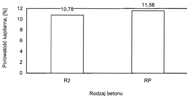
Rys. 7. Wyniki badań porowatości kapilarnej betonów o C/W=1,6 (RP) i C/W=2,5 (R2)
